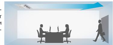
В режиме отопления теплый воздух направлен вниз к полу, чтобы избежать коротко замкнутого воздушного потока и обогреть самые холодные углы комнаты.
