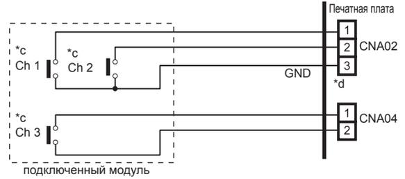
\*в Выберите контакты для очень низкого значения силы тока (предназначенные для 12 В постоянного тока, 1 мА постоянного тока или менее).
