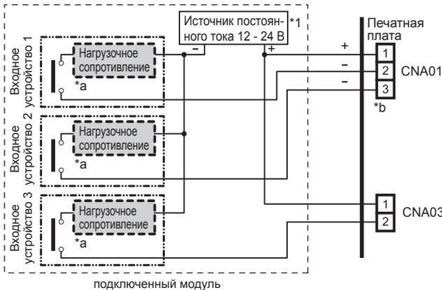
\*1 Используйте источник питания постоянного тока 12-24 В. Выберите источник питания с достаточной для подсоединяемой нагрузки мощностью.
