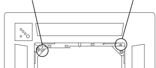
\* Выровняйте прштампованные отметки на кассетной решетке по трубе и дренажу внутреннего модуля.
