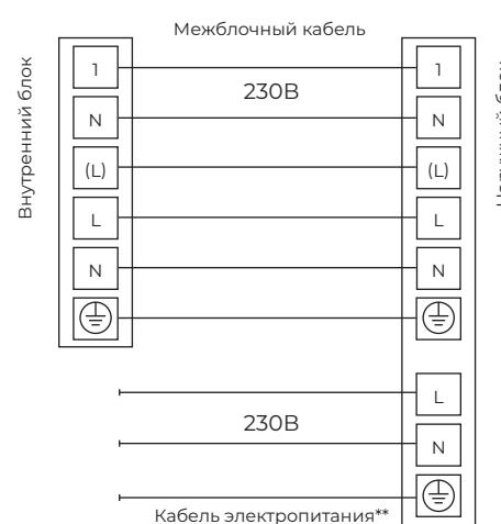
\* Кабель электропитания подключен к плате управления внутреннего блока
