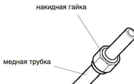
Рис.12: Установка накидных гаек
