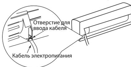
3. Снимите хомут; подсоедините кабель электропитания к клеммам электрощитка (в соответствии с цветом); затяните винты и зафиксируйте кабель хомутом.
