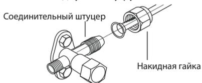
4. Затяните накидную гайку динамометрическим ключом с моментом, указанным в таблице ниже.
