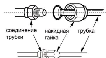
3. Отрегулируйте затягивающее усилие согласно следующей таблице. Поместите открытый ключ на соединение трубки и наденьте динамометрический ключ на накидную гайку. Затяните накидную гайку динамометрическим ключом.
