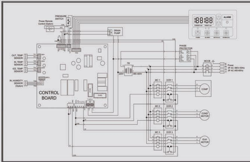
Электрическая схема ICEN (модели WPC-23000 Трехфазная версия)
