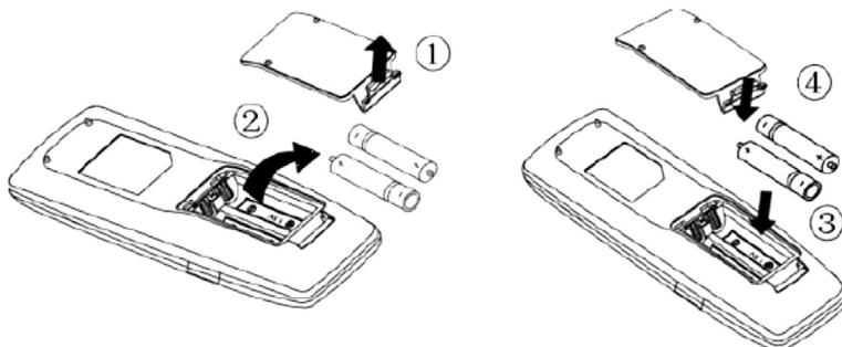
В пульте управления применяются две батарейки 1,5 В типа AAA. Не допускается использовать одновременно батарейку, выработавшую ресурс, и новую, а также батарейки разных типов. Срок службы батареек не более 1 года.
