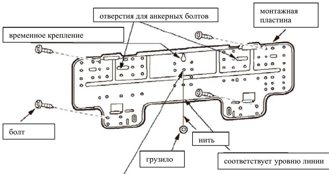
**Пропустите нить через центрированное отверстие. Убедитесь в соответствии уровня пластины с помощью подвешивания нити с грузом через центральное отверстие пластины, затем плотно закрепите пластину болтами.**
